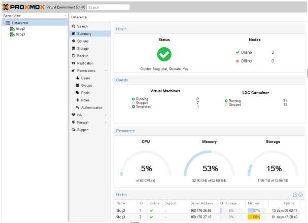
Ilustración 53 Panel de control del sistema Proxmox para monitorización y gestión de recursos
